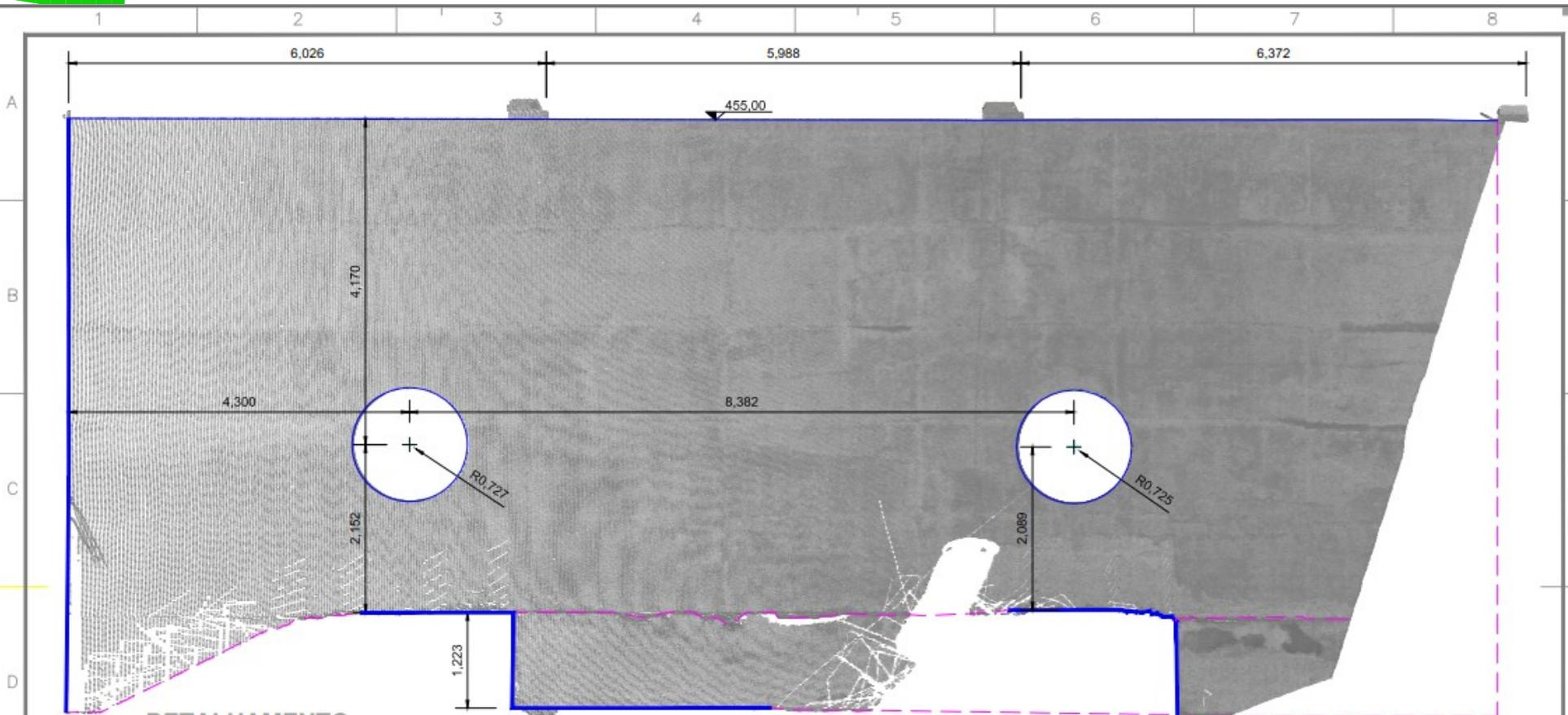
**DETALHAMENTO PAREDE A MONTANTE - CASA DE MÁQUINAS**
