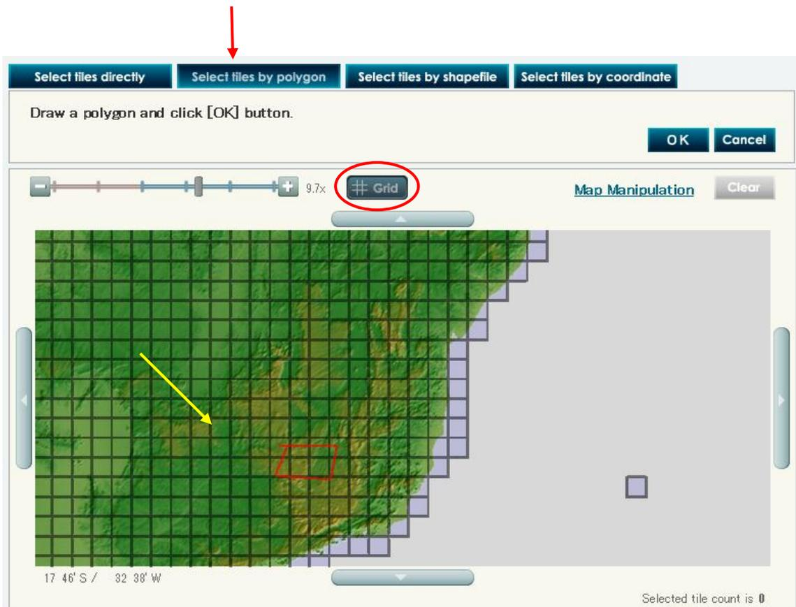
b-2) Depois de desenhar o polígono clique em **OK**. E em seguida no **“Fix the polygon”** novamente em **OK**. Após isso aparecerá a área demarcada, clique em **Next**.
