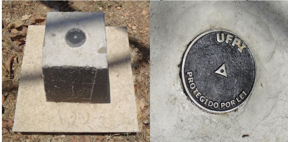
Figura 4 – Vista de um marco geodésico implantado e de sua chapa de alumínio.
